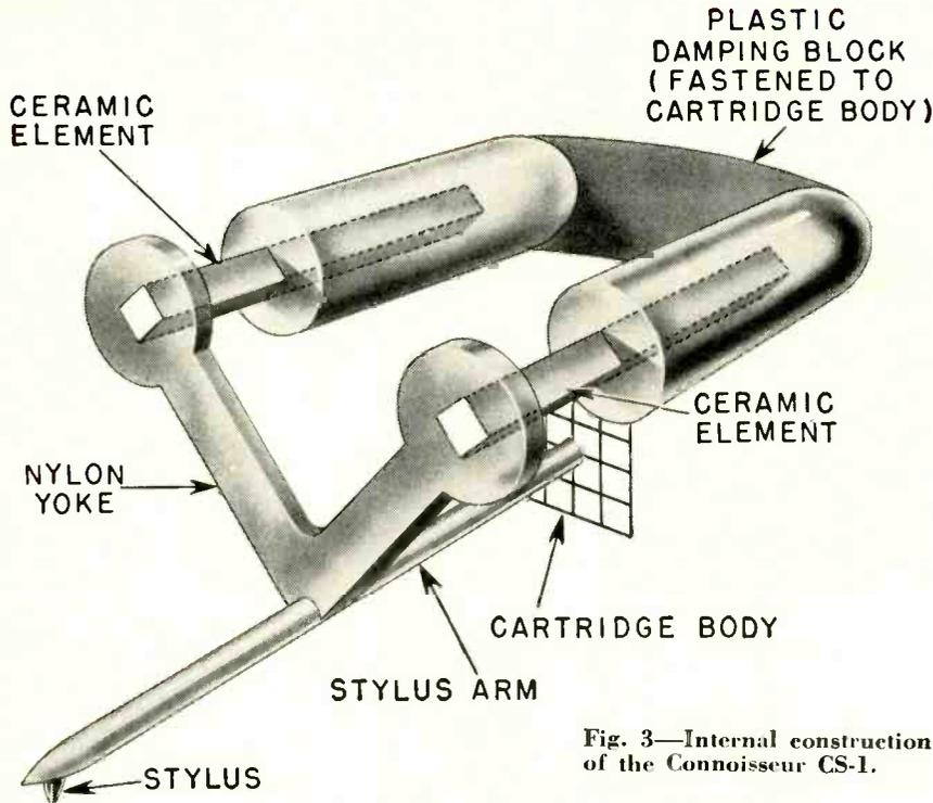
Fig. 3—Internal construction of the Connoisseur CS-1.
